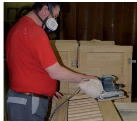
Mittels Handarbeit erfolgt der Feinschliff.
