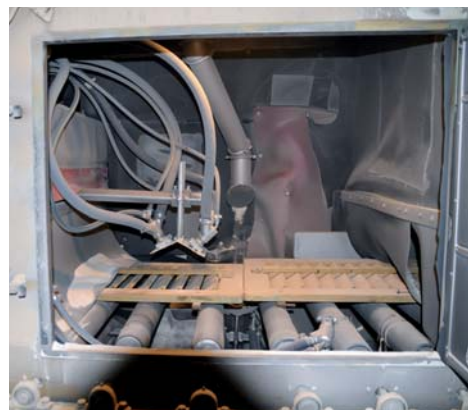
Glasmehlstrahlmaschine entfasert die Läden.
