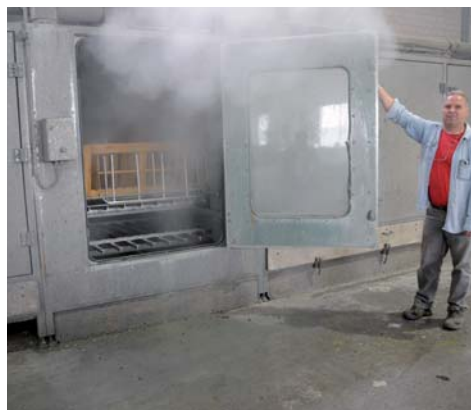
Erste Station im Ablauf ist der Ablaugautomat.
